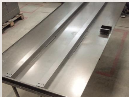
Внутри двери продольные рёбра жёсткости
